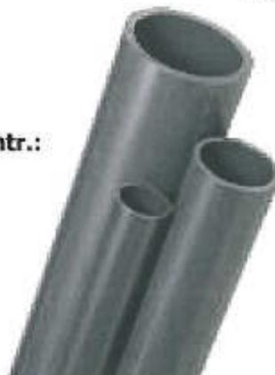
DIE ROHRE SIND AUS WEICHMACHERFREIEM PVC-U=POLYVINYLCHLORID-UNPLASTIZIERT 100 GEFERTIGTE, NORMAL SCHLAGZÄHE ROHRE. DIE OBERE DAUERGEBRAUCHSTEMPERATUR LIEGT BEI 60 GRAD C (333,15K). BEI TEMPERATUREN UNTER 0 GRAD (273,15 K) ERHÖHT SICH DIE SCHLAG- UND STOSSEMPFINDLICHKEIT. DER TEMPERATUREINSATZBEREICH RICHTET SICH NACH DEN AUFTRETENDEN MECHANISCHEN BELASTUNG.
